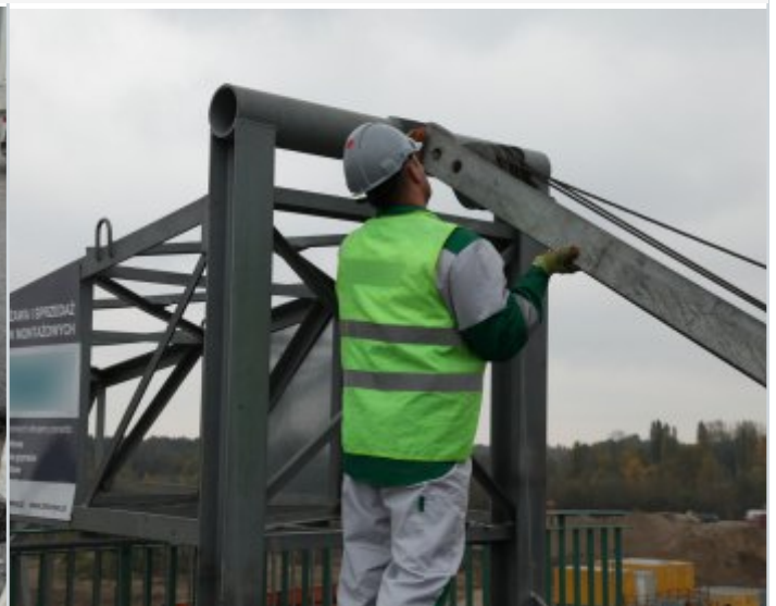
12. Wózek montażowy ze złożonym ramieniem (możliwe pokonywanie przeszkód typu słupki, latarnie itp.)
