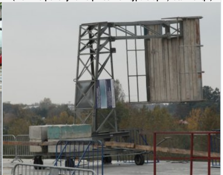
12. Wózek montażowy ze złożonym ramieniem (możliwe pokonywanie przeszkód typu słupki, latarnie itp.)
