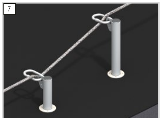
Sposób prowadzenia linki napinającej
