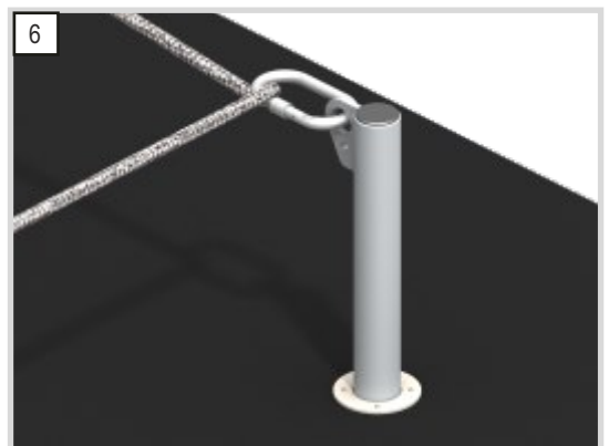
Sposób montażu liny kotwicznej na narożach budynku
