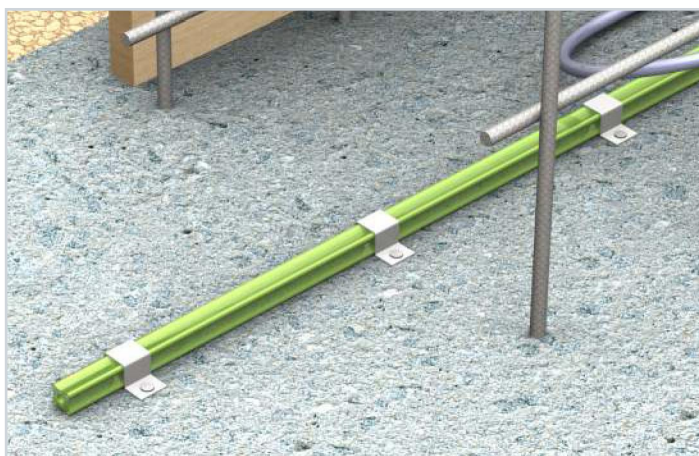
3. Montaż węża iniekcyjnego przy pomocy uchwytych montażowych w rozstawie co ok. 25 cm.
