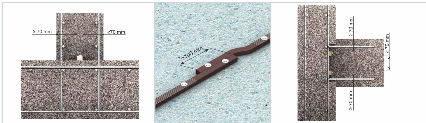
Uszczelnienie styku płyty i ściany fundamentowej
