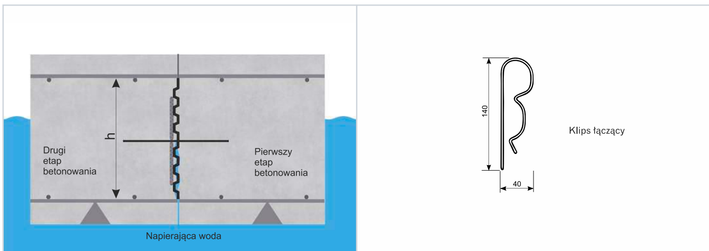
Montaż elementu szalunkowego ABS
