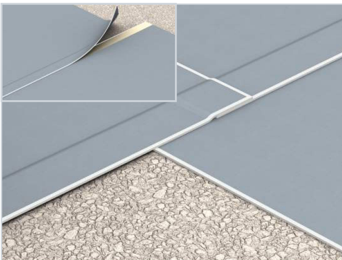
1. Rozwinięcie maty na przygotowanym podłożu oraz wykonanie zakładów połączeniowych.
