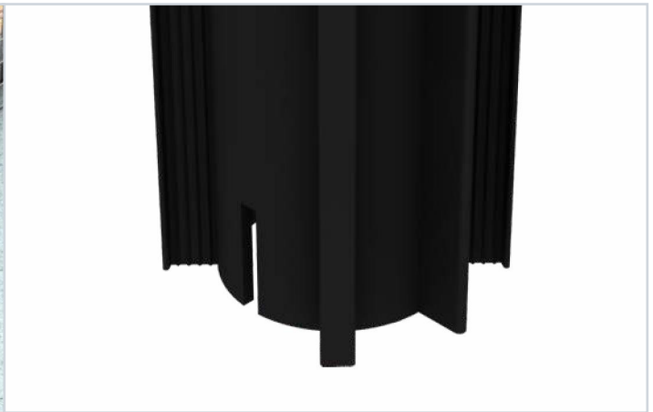
Nacięcie dolnej części rury oraz docięcie pod wymiar.
