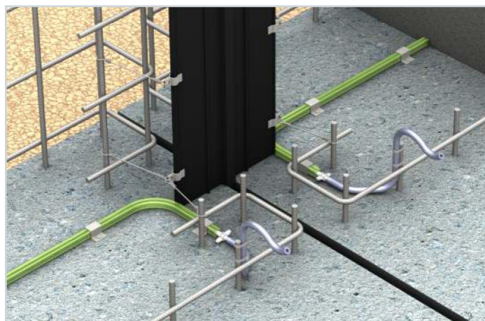
Rys. 4. Montaż węzła w obrębie dylatacji zabezpieczonej wewnętrzną taśmą uszczelniającą.
