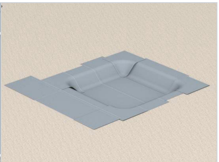
2. Wykonanie izolacji przegłębienia płyty fundamentowej.
