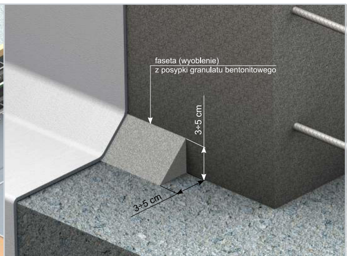
4. Detal wykonania fasety ze szpachli bentonitowej we wklęsłych załamaniach konstrukcji.
