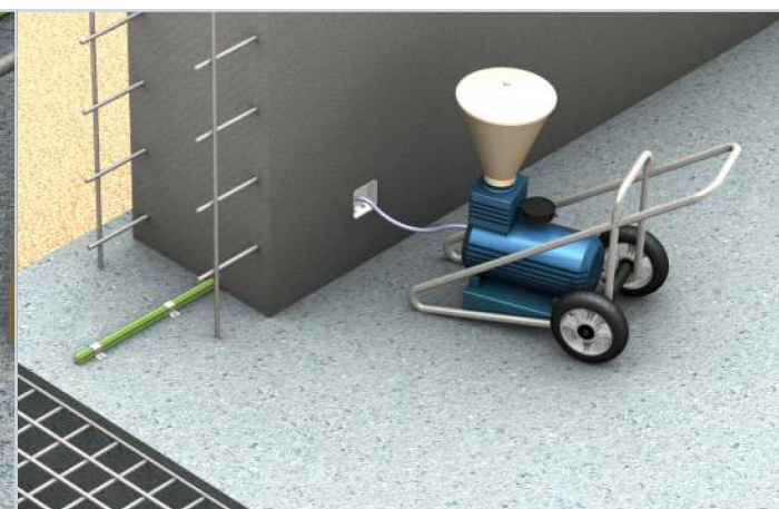
5a. Betonowanie elementu konstrukcji. Wykonanie iniekcji po dociążeniu styków ok. 80% masy własnej konstrukcji.
