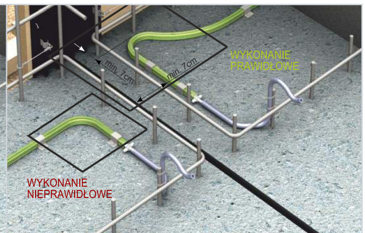
Rys. 5. Montaż węzła w obrębie dylatacji zabezpieczonej zewnętrzną taśmą uszczelniającą.
