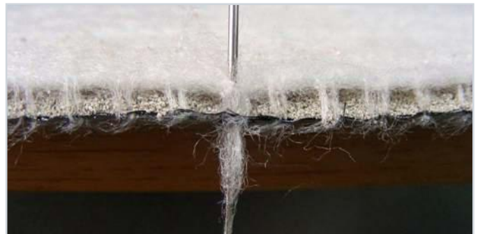
Przekrój maty Izotex, widoczne igłowanie
