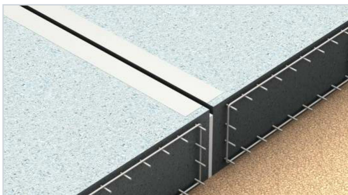
Przygotowanie podłoża. Zagruntowanie oraz nałożenie kleju uszczelniającego do połączeń.
